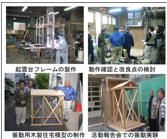
図-8 自作組み立て起震台の製作風景
